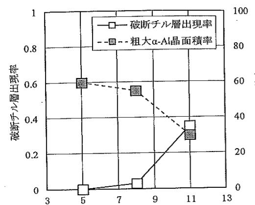
図13 粗大α-Al晶の面積率と破断チル層出現率に及ぼすSi含有量の影響<sup>9)</sup>
